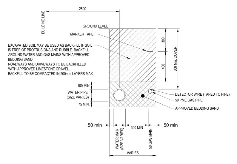
TYPICAL SECTION OF JOINT USE TRENCH - GAS & WATER (ST2)
